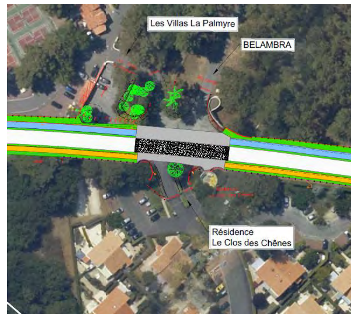
Figure 194 : Plateau au niveau des Villas La Palmyre
